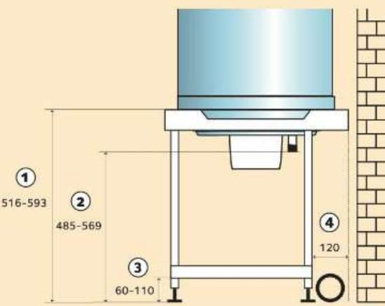
1. Distance entre le point d'appui et le sol
